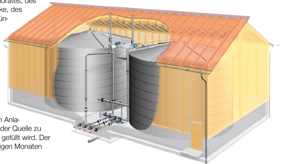
Die schematische Darstellung des Innenlebens des Hochbehälters
