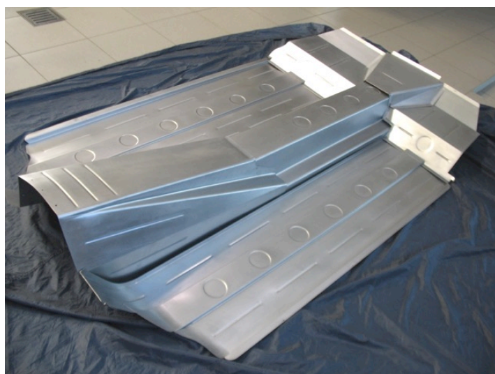
Individuell angefertigtes Bodenblech für den Audi quattro Trans-Am
